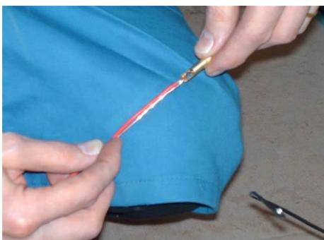
3. Retourner l'*âme* en cuivre sur l'isolant.
