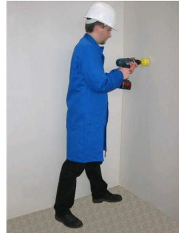
2. Prendre une *posture* pour avoir la meilleure stabilité possible lors du *perçage*. Vérifier le sens de rotation de la perceuse (sens de vissage : ↻)
