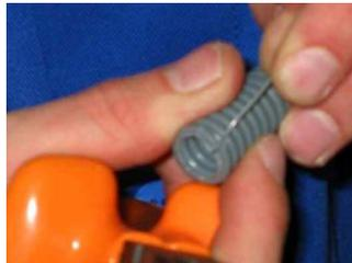
b. Coincer l'*aiguille* métallique dans l'encoche.
